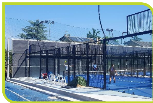
Schermatura altezza 6 mt per campi da padel
